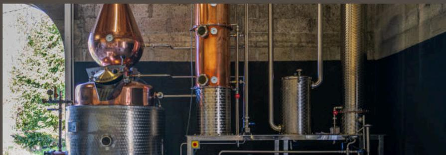
Nous sommes équipés d'un alambic hybride de 500L fabriqué par DES ainsi que d'une salle de brassage pour effectuer toutes les étapes de production au sein de la distillerie. Embouteillage et étiquetage sont aussi fait dans notre distillerie. Les vieillissements sont aussi réalisés dans notre chai à barrique, en sous-sol.
